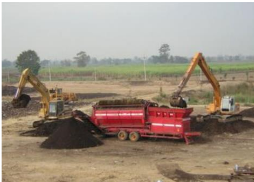
ภาพ 31 เครื่องร่อนขยะหลังจากการบำบัดด้วยกรรมวิธีเชิงกล-ชีวภาพPassive Aerated Windrow
