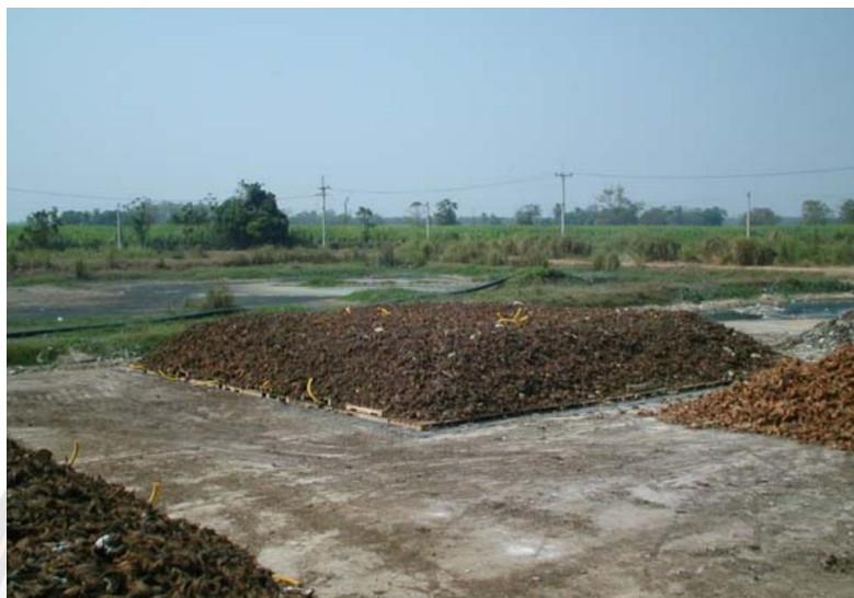
ภาพ 30 กองหมักขยะบำบัดด้วยวิธี Passive Aerated Windrow
