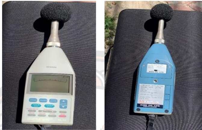
ภาพ 10 เครื่องวัดเสียงรุ่น ST-107 Tenmars และชุดอุปกรณ์ที่ใช้ในการวัดระดับเสียง
