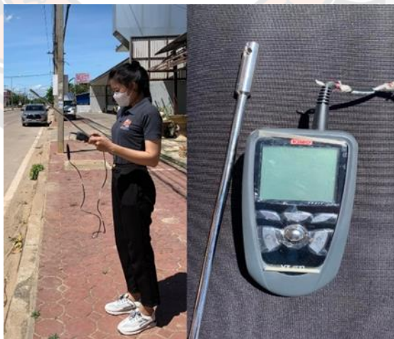
ภาพ 14 เครื่องมือวัดระดับความเร็วลมในบรรยากาศ
