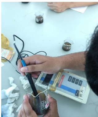
ภาพ 37 เครื่องวัดค่า EC และ pH Consort C931 electrochemical Analyzer pH probe
