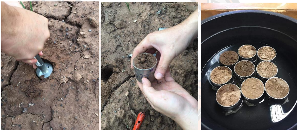
ภาพ 35 กระป๋องเก็บดิน (Soil Core) และอุปกรณ์เก็บตัวอย่างดิน
