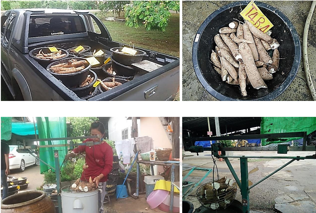
ภาพ 33 การวัดเปอร์เซ็นต์แป้งโดยใช้เครื่องชั่งแบบความถ่วงจำเพาะด้วยน้ำ Riemann Scale Balance (specific gravity) ในหัวสตร (Tuber)
