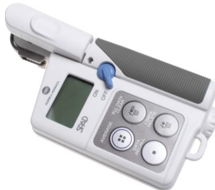
ภาพ 36 เครื่องวัดคลอโรฟิลล์ในใบพืช (Chlorophyll Meter SPAD-502 Plus)
