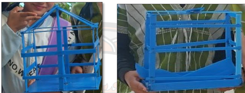
ภาพ 8 ตัวอย่างการออกแบบฐานของแพไฟเป็นรูปเรขาคณิต โดยกำหนดให้ฐานเป็นรูปทรงปริซึมและลอยน้ำได้
