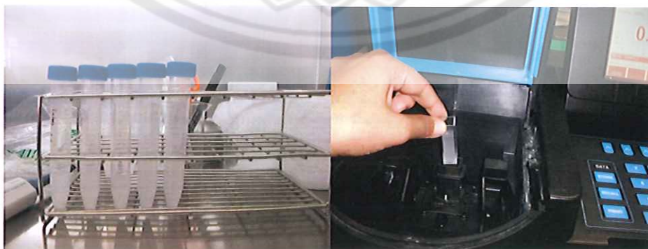
ภาพภาคผนวกที่ 11 วัดค่า OD 600 nm ด้วยเครื่อง spectrophotometer
