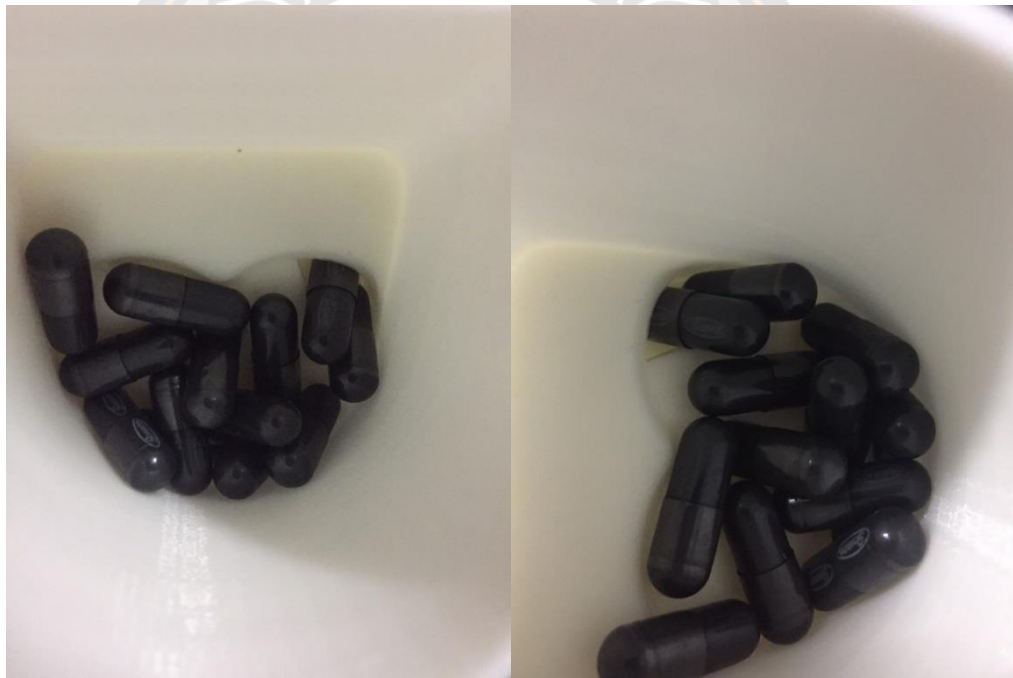
ภาพ 66 ตัวอย่างของผลการทดสอบในกรณีที่เม็ดยาเกิดการซ้อนกันในร่องจับเม็ดยาสำหรับเม็ดยาชนิด A3 (จากการทดสอบ)
