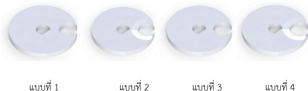
ภาพ 58 ตัวอย่างการแบ่งระยะเผื่อที่เหมาะสม (Clearance) 4 แบบ
