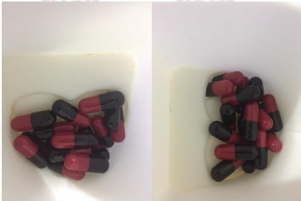
ภาพ 70 ตัวอย่างของผลการทดสอบในกรณีที่เม็ดยาเกิดการซ้อนกันในร่องจับเม็ดยาสำหรับเม็ดยาชนิด A5 (จากการทดสอบ)
