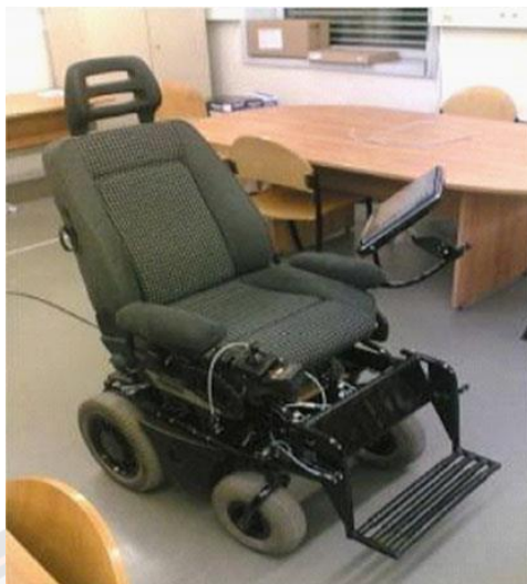
ภาพ 14 เก้าอี้เข็นที่ติดตั้งระบบเก้าอี้เข็นอัจฉริยะเชิงหุ่นยนต์
