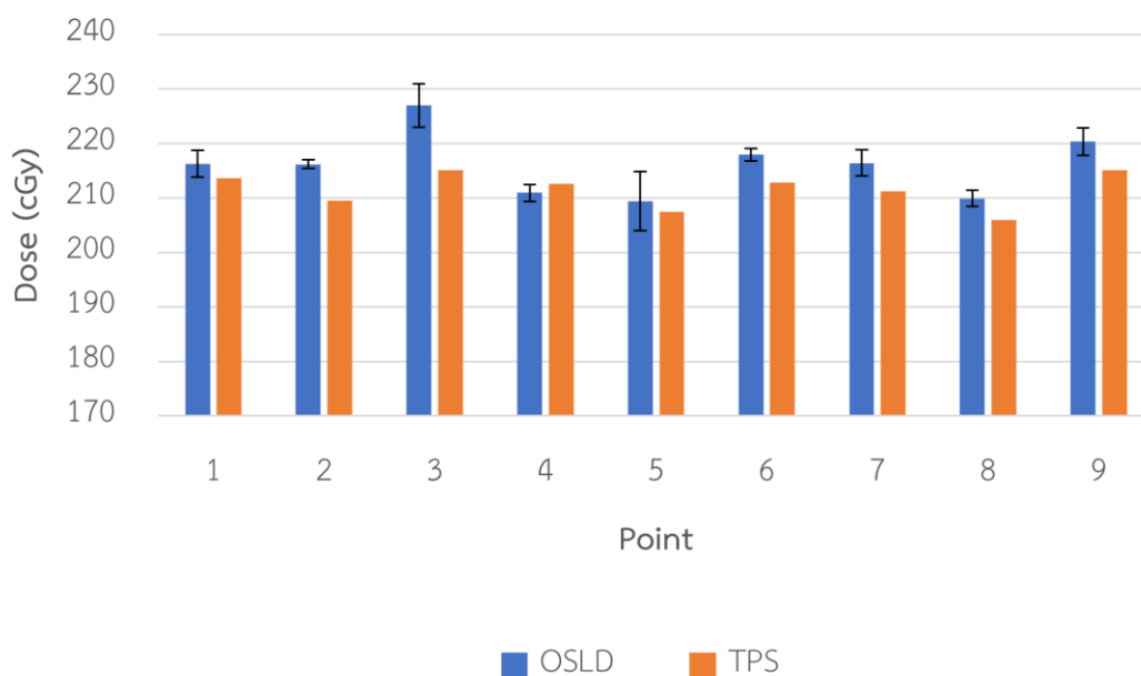
ภาพ 47 แสดงปริมาณรังสีเฉลี่ยจากการวัดในหุ่นจำลอง 9 ตำแหน่ง จากแผนการรักษาวัสดุสมมูลเนื้อเยื่อเสมือน ความหนา 15 มิลลิเมตร และ -100 HU
