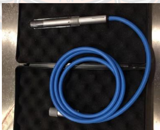
ภาพ 17 แสดง Ionization chamber 0.6 ลูกบาศก์เซนติเมตร รุ่น TW30013 ยี่ห้อ PTW
