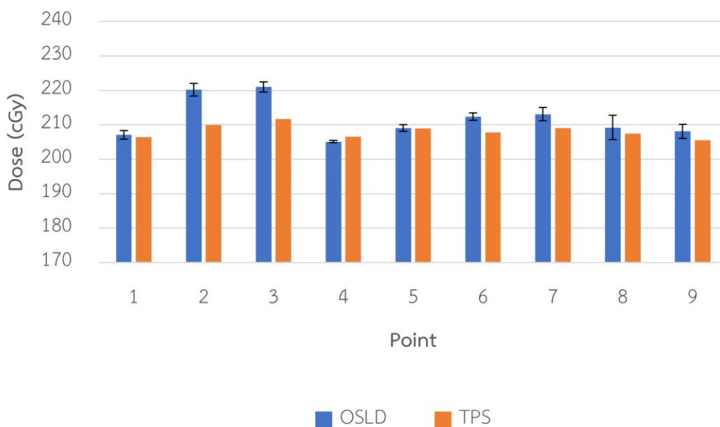
ภาพ 37 แสดงปริมาณรังสีเฉลี่ยจากการวัดในหุ่นจำลอง 9 ตำแหน่ง จากแผนการรักษาแบบไม่ใส่วัสดุสมมูลเนื้อเยื่อเสมือน
