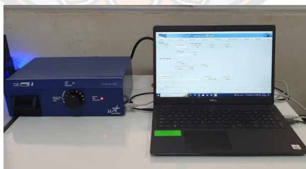
ภาพ 8 แสดงเครื่องอ่านค่านับวัด รุ่น MicroStar
