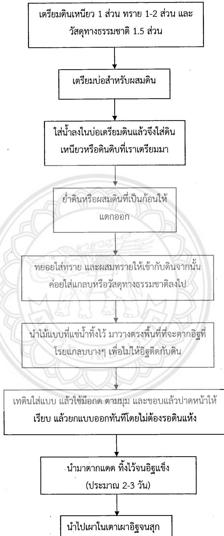
รูปที่ 2.2 แผนผังการผลิตอิฐดินเผา ที่มา : จิตร (2550)
