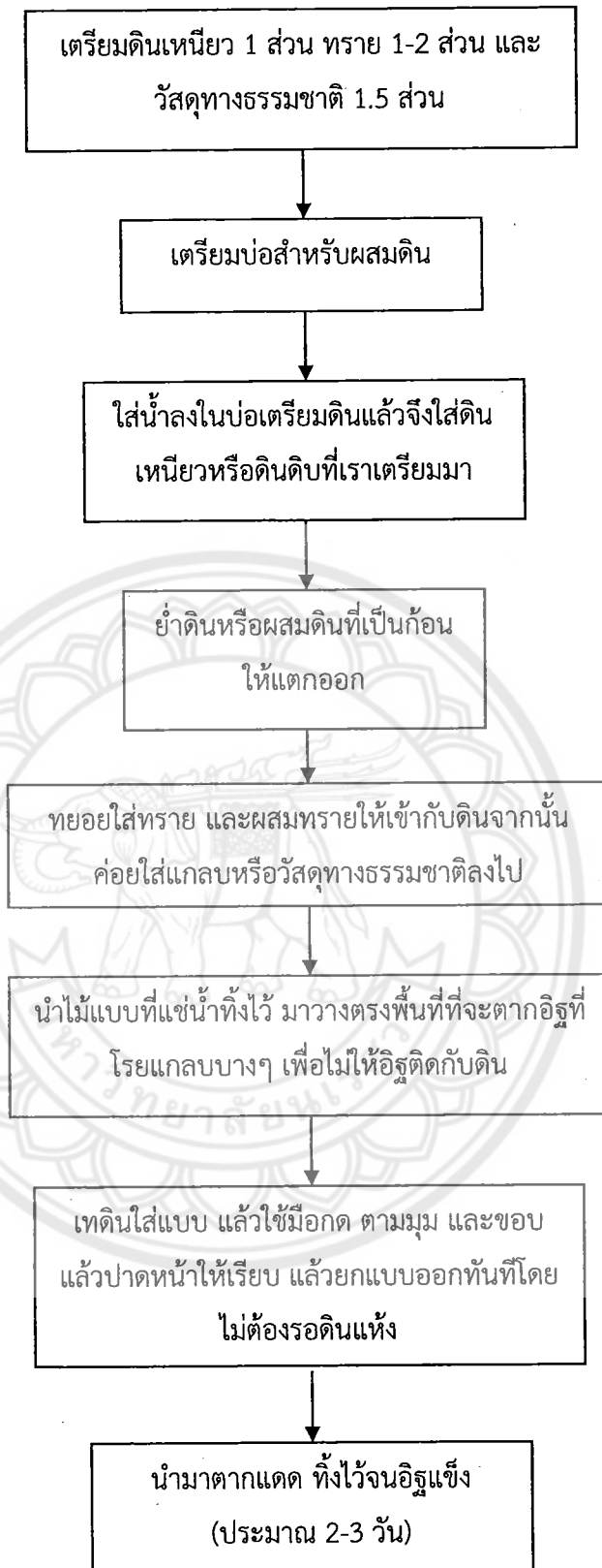
รูปที่ 2.1 แผนผังการผลิตอิฐดินดิบ
