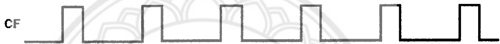
รูปที่ 2.4 รูปสัญญาณเอาต์พุตของ ไอซี ADE7755
