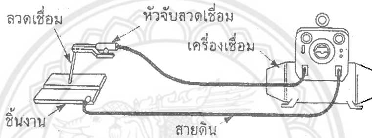
รูปที่ 2(ค) อุปกรณ์ของกระบวนการเชื่อมด้วยลวดเชื่อมหุ้มฟลักซ์
