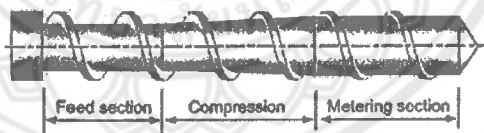
รูปที่ 2.15 ลักษณะและส่วนต่าง ๆ ของสกรูเครื่องอัดรีดแบบเกลียวหนอนเดียว
