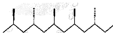
รูปที่ 2.5 ลักษณะการจัดเรียงตัวโครงสร้างโมเลกุลแบบอะแทกติกแทกติกของพอลิพรอพิลีน
