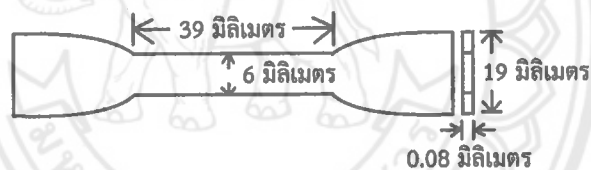
รูปที่ 3.3 ขนาดชิ้นงานที่ใช้ทดสอบการต้านทานแรงดึง
