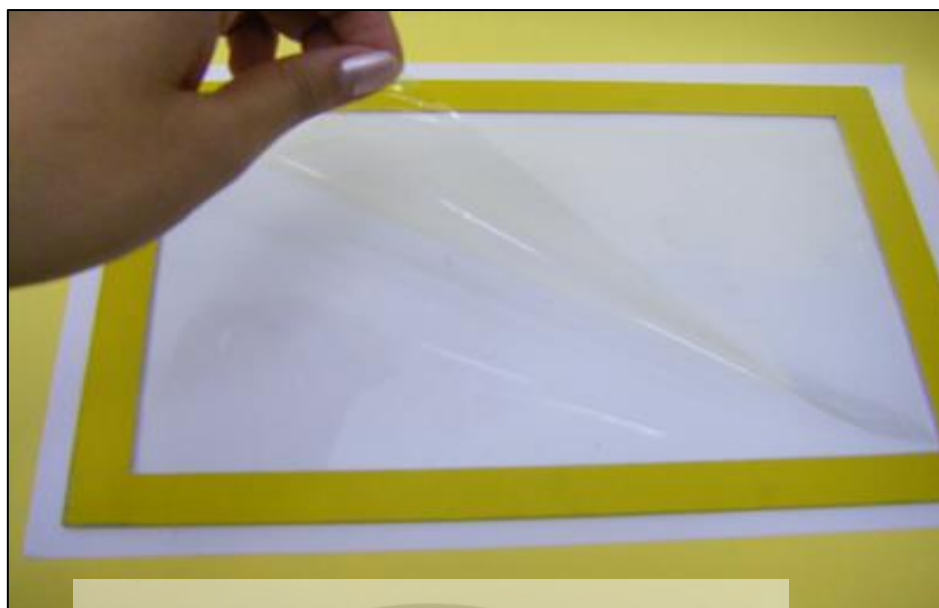
รูปที่ 2.9 ลักษณะของแผ่นฟิล์มที่ได้หลังทำการขึ้นรูปโดยใช้ตัวทำละลาย (MGR online, 2018)
