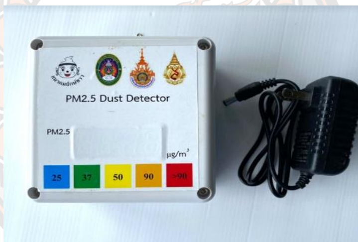
ภาพที่ 20 แสดงเครื่องวัดค่าคุณภาพอากาศ PM2.5
