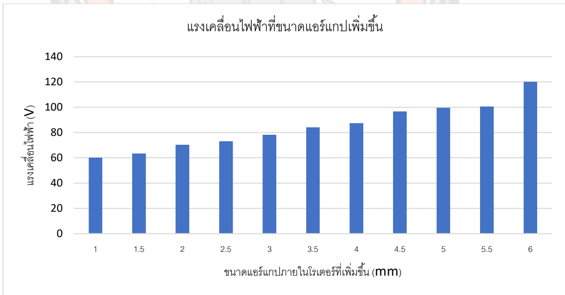
ภาพ 53 กราฟเปรียบเทียบการคำนวณแรงเคลื่อนไฟฟ้าที่มีการเพิ่มขนาดแอร์แกป
