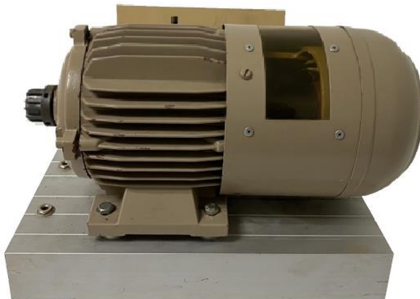
ภาพ 67 เครื่องกำเนิดไฟฟ้าโรเตอร์ออกแบบด้วยวิธีไฟไนต์เอลิเมนต์ที่ประกอบเสร็จสมบูรณ์
