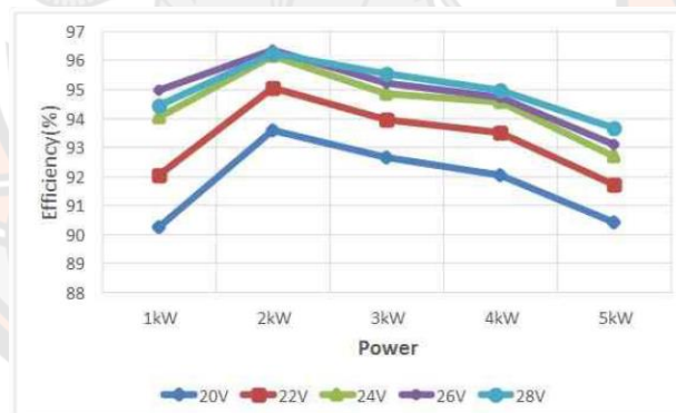
รูปที่ 2-25 ประสิทธิภาพเปรียบเทียบกับแรงดันแบตเตอรี่แบบเปลี่ยนความถี่ [9]
