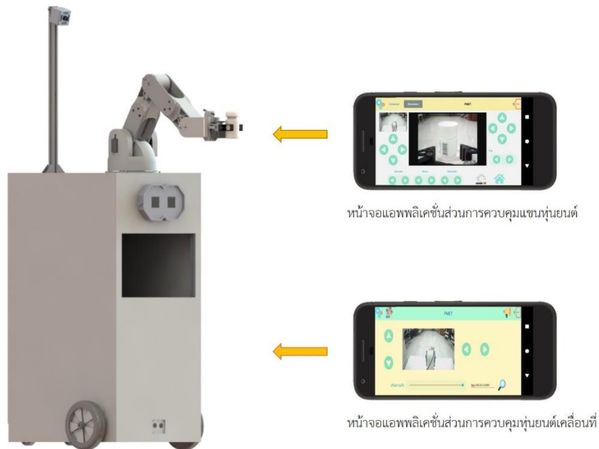
ภาพ 71 การควบคุมหุ่นยนต์ผ่านแอปพลิเคชันบนสมาร์ทโฟน
