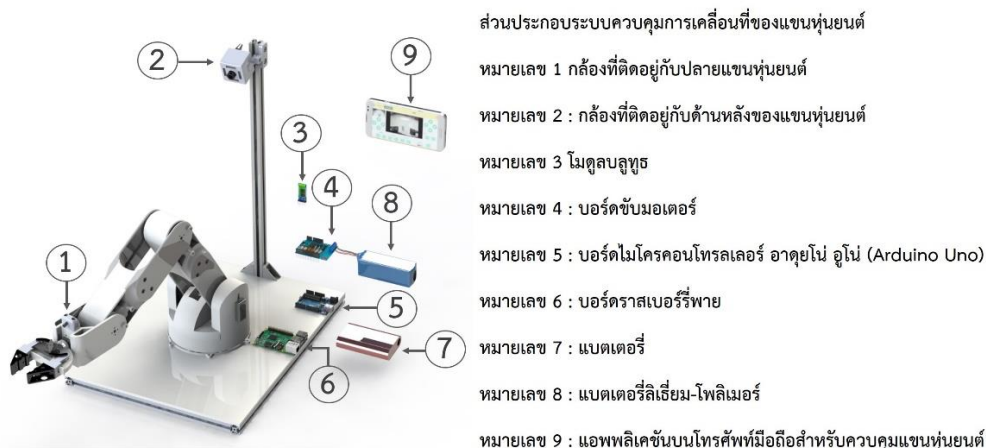
ภาพ 62 ส่วนประกอบระบบควบคุมการเคลื่อนที่ของแขนหุ่นยนต์
