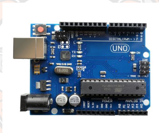
ภาพ 27 บอร์ด Arduino Uno R3
