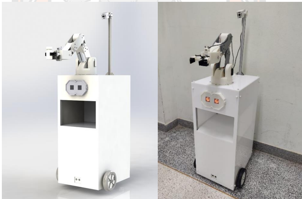
ภาพ 50 โครงสร้างหุ่นยนต์บริการสำหรับผู้ป่วยติดเตียงต้นแบบ
