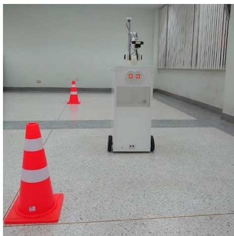
ภาพ 94 การทดสอบการเคลื่อนที่ของหุ่นยนต์ไป-กลับ
