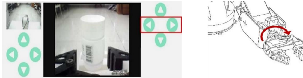
ภาพ 83 ลักษณะการเคลื่อนที่ของแขนข้อมือ โดยการควบคุมส่วนการหมุนข้อมือของแขนข้อมือ
