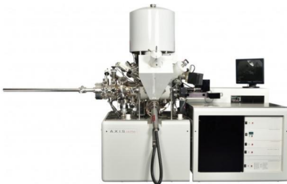
ภาพ 36 เครื่อง X-ray Photoelectron spectroscopy ยี่ห้อ Kratos Analytical รุ่น Axis Ultra DLD
