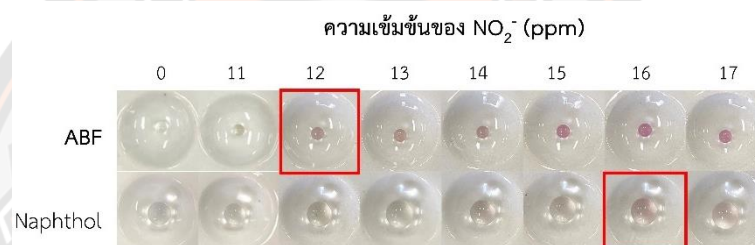
ภาพ 62 การเปลี่ยนแปลงสีของเม็ดพอลิอะคริเลตเจลสำเร็จรูปที่ดูดซับ ABF/Naphthol (60 ppm) ก่อนและหลังการแช่ในสารละลาย Naphthol/ABF (60 ppm) ที่ผสมสารละลาย \text{NO}_2^- ที่ความเข้มข้นต่างๆ เป็นเวลา 20 นาที
