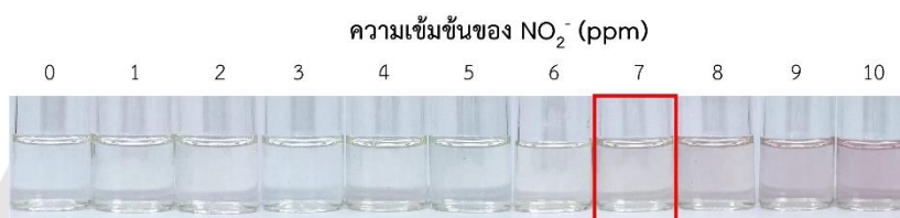
ภาพ 31 การเปลี่ยนแปลงสีของสารละลายผสม ABDF (40 ppm) + Naphthol (40 ppm) เมื่อเติม \text{NO}_2^- ที่ความเข้มข้นต่างๆ ในระบบตัวทำละลายผสม MeCN:H 2 O (1:4) และทิ้งสารผสมไว้เป็นเวลา 40 นาที
