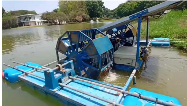
ภาพ 65 ภาพเครื่องเติมอากาศในขณะที่มีการระบายน้ำออกจากของ
