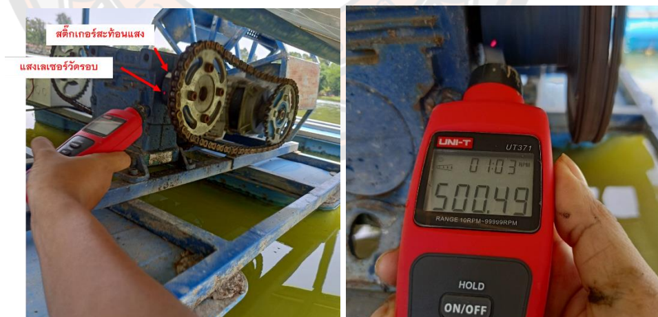
ภาพ 66 ใช้ Tachometer วัดความเร็วการหมุนของมอเตอร์
