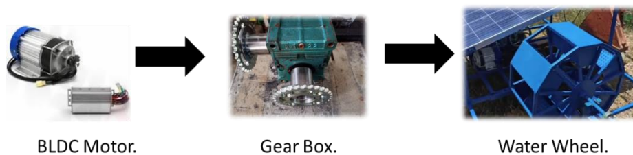
ภาพ 41 ชุดมอเตอร์ เกียร์ทด แล้วเพลาล้อยึดน้ำ
