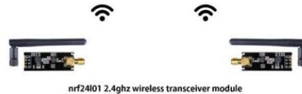
รูปที่ 1 nrf24l01 2.4 GHz wireless transceiver module ที่ใช้ใ้การรับส่งข้อมูลไร้สาย
