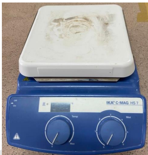
ภาพ 21 เตาแผ่นให้ความร้อนแบบมีเครื่องคนสารด้วยแม่เหล็ก
