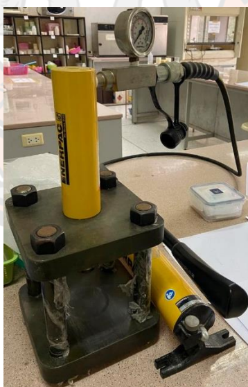
ภาพ 25 เครื่องอัดระบบไฮดรอลิก ยี่ห้อ ENERPAC รุ่น P77 ความดันสูงสุด 700 bar/10000 psi บริษัท Enerpac ประเทศอินเดีย
