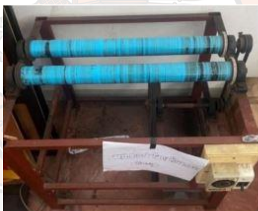
ภาพ 20 แท่นหมุนพร้อมมอเตอร์สำหรับหมุนกระป๋อง เพื่อบดย่อยผสมสารแบบ Ball milling
