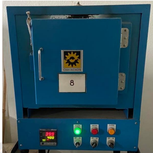
ภาพ 23 เตาเผาไฟฟ้าอุณหภูมิสูง ผลิตโดยบริษัท ชวโชติ จำกัด ประเทศไทย
