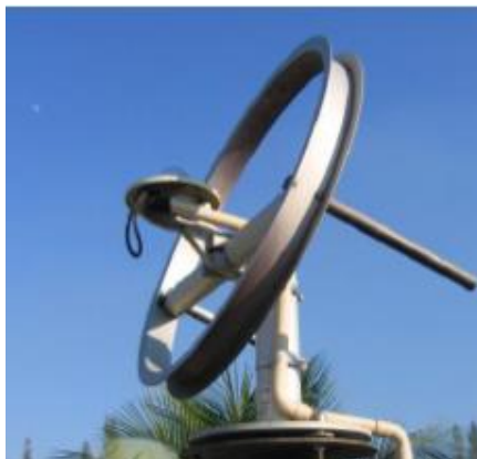
ภาพ 17 เครื่องวัดรังสีกระจายแบบใช้วงแหวนบังรังสีตรงซึ่งผลิตโดยบริษัทคิปปี้แอนด์โซเนนซ์ของมหาวิทยาลัยศิลปากรซึ่งติดตั้งที่สถานีเชียงใหม่ (43)
