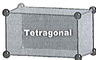
ภาพที่ 18 ระบบผลึกแบบเทตระโกนัล
