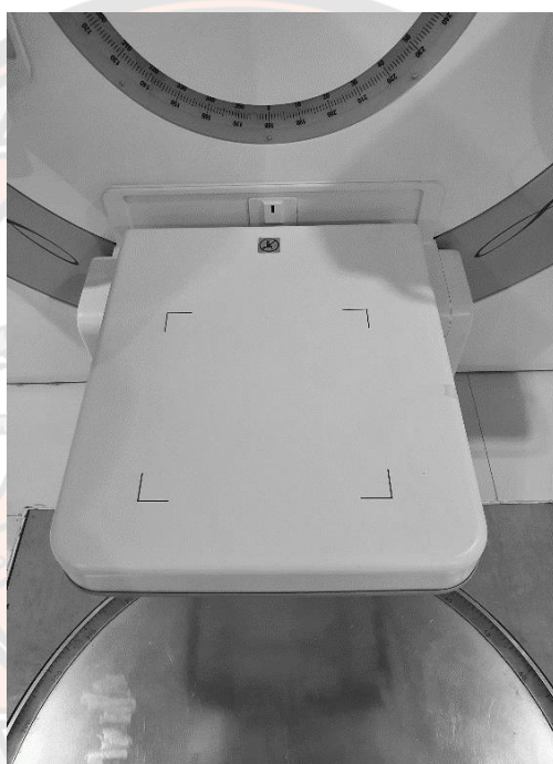
ภาพ 17 อุปกรณ์รับภาพอิเล็กทรอนิกส์ ELEKTA iViewGT รุ่น R 3.4
