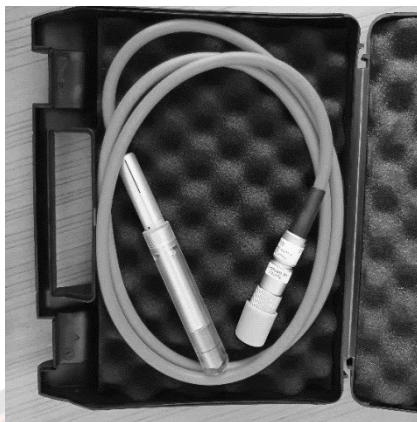
ภาพ 12 ไอออนไนเซชันแชมเบอร์ ยี่ห้อ PTW รุ่น Farmer
