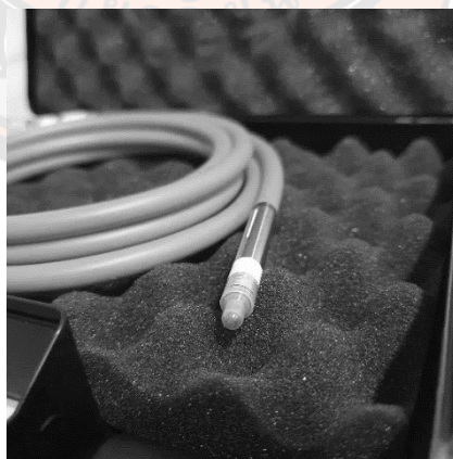
ภาพ 13 ไอออนไนเซชันแชมเบอร์ ยี่ห้อ PTW ชนิด Pinpoint 3D
