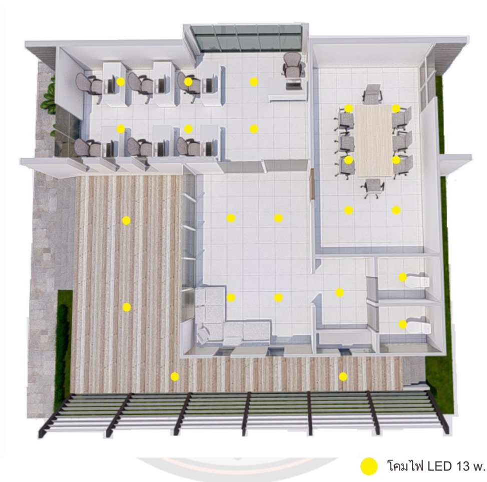
ภาพ 31 แสดงแบบผังระบบไฟฟ้าแสงสว่างอาคาร ( Lighting Plan )
