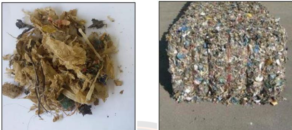
ภาพ 9 ลักษณะของขยะมูลฝอยที่ผ่านการแปรรูปเป็นเชื้อเพลิง RDF
