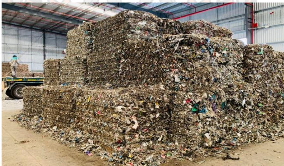
ภาพ 3 ตัวอย่างเชื้อเพลิง RDF ประเภทที่ 2 และ 3
