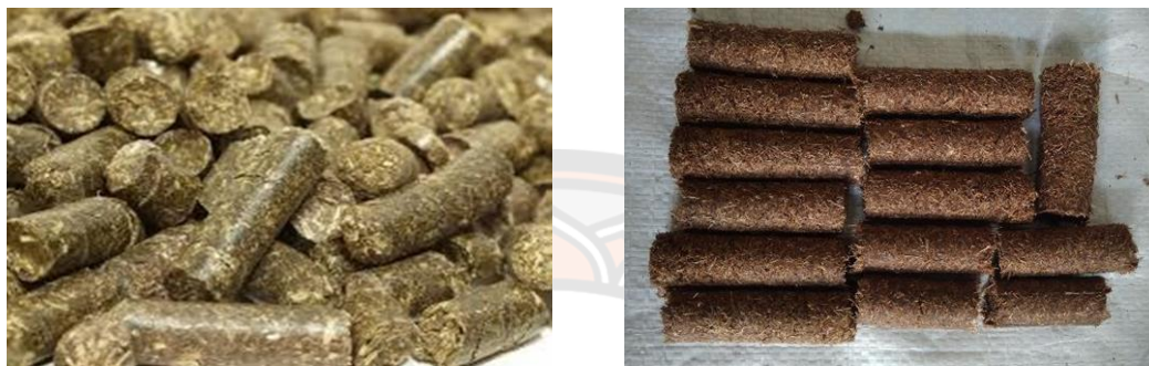
ภาพ 4 ตัวอย่างเชื้อเพลิง RDF ประเภทที่ 4 และ 5
