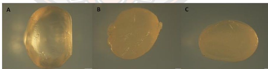
ภาพ 38 แสดงภาพจากกล้อง Stereoscope (กำลังขยาย 5.75X) เป็นภาพตัดขวางของ SNP-Ro-CaCl 2 beads ที่สังเคราะห์โดยใช้ความเข้มข้นของ CaCl 2 ที่ต่างกัน A: SNP-Ro-1% CaCl 2 bead B: SNP-Ro-3% CaCl 2 bead และ C: SNP-Ro-5% CaCl 2 bead
