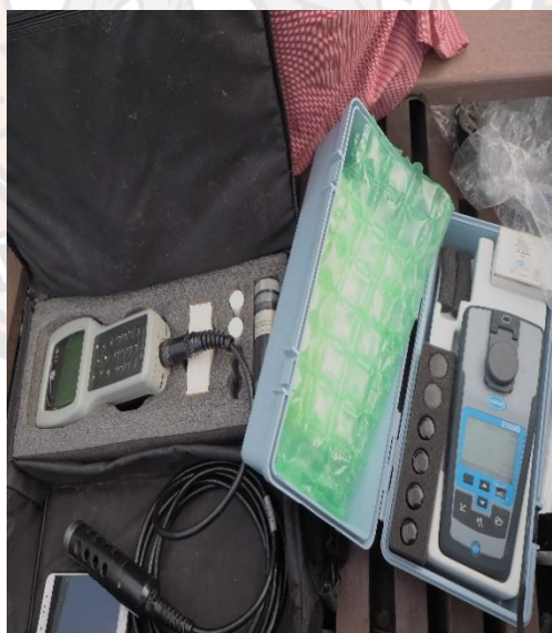
ภาพผนวก ข2 เครื่องตรวจวัดคุณภาพน้ำภาคสนาม
