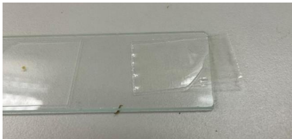
ภาพ 13 สไลด์ที่เตรียมด้วยวิธี Wet scotch tape adhesion technique
