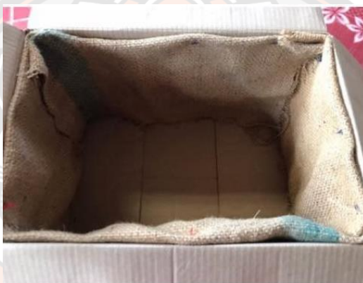
ภาพ 12 แสดงแบบจำลองห้องดนตรีโดยใช้กระสอบเป็นวัสดุดูดซับเสียง
