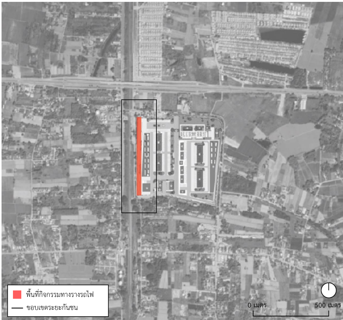
ภาพ 22 การกำหนดระยะกันชนของพื้นที่กิจกรรมทางรางรถไฟขนาด 100 เมตร
