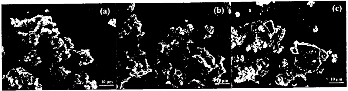
รูปที่ 4.6 ภาพ SEM images ของตัวเร่งปฏิกิริยาหลังการเผาแคลไซน์ (a) \text{CaO}:\text{SiO}_2=0.5 \text{CaO}:\text{SiO}_2=1 catalyst และ (c) \text{CaO}:\text{SiO}_2=2
