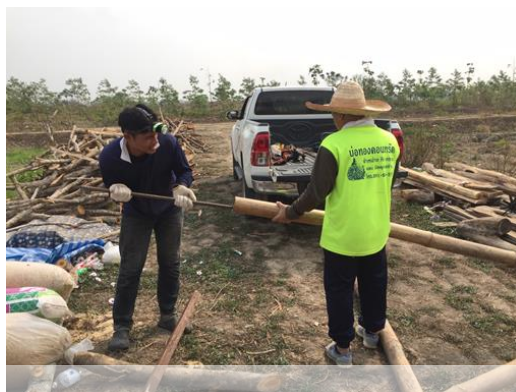
รูปที่ 4.40 การทะลวงไม้ไผ่ ของเตาต้นแบบ
