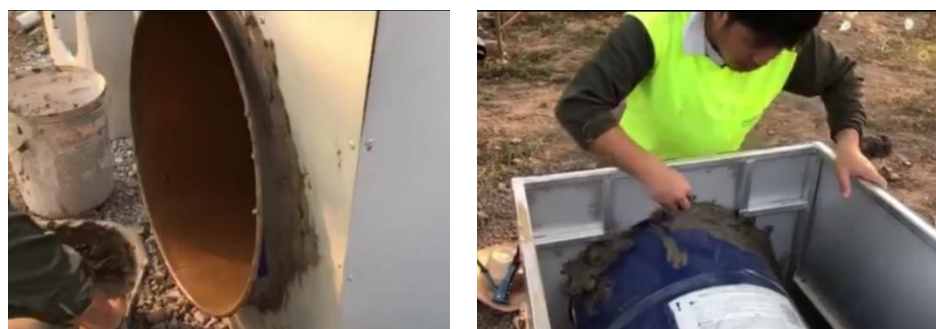
รูปที่ 4.37 การประสานรอยต่อด้วยดิน ของเตาต้นแบบ
