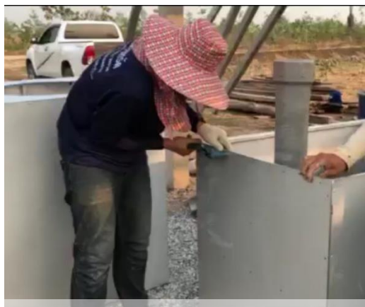
รูปที่ 4.38 การยิงรีเวทด้านหลัง ของเตาต้นแบบ
