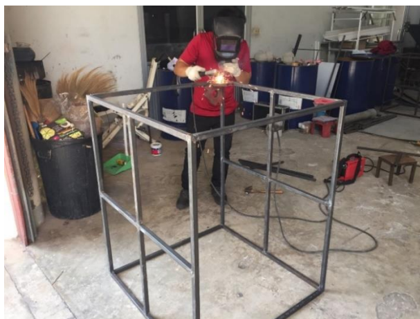
รูปที่ 4.18 การเชื่อมแต่ละด้านประกบกัน ของเตาดังแบบ
