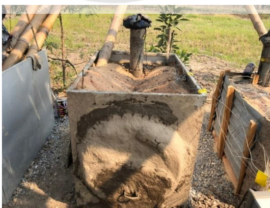
รูปที่ 3.23 ลักษณะการปิดเตาของเตาดั้งแบบ
