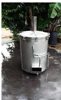
รูปที่ 2.5 เตาเผาถ่านถึง 200 ลิตร แบบซูเปอร์ซัน
