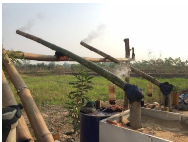
รูปที่ 3.21 วิธีการเก็บน้ำส้มควันไม้ ของเตาดันแบบ
