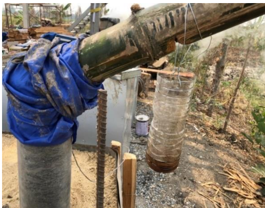
รูปที่ 3.12 วิธีการเก็บน้ำส้มควนไม้ของเตาแบบดั้งเดิม
