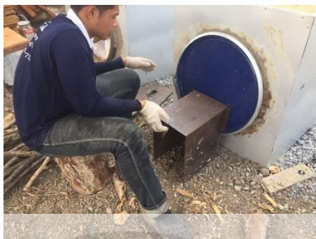
รูปที่ 3.17 การประกอบช่องเชื้อเพลิง ของเตาต้นแบบ
