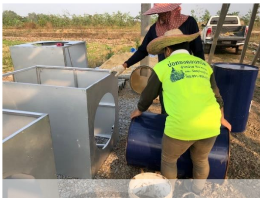
รูปที่ 4.34 การนำถังวางในโครงเตา ของเตาดั้งแบบ
