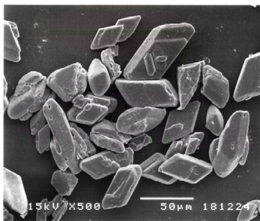
รูปที่ 2.5 ภาพถ่ายจากกล้องจุลทรรศน์ของยิปซัมฟลูแก๊สหลังการล้างทำความสะอาด [7]
