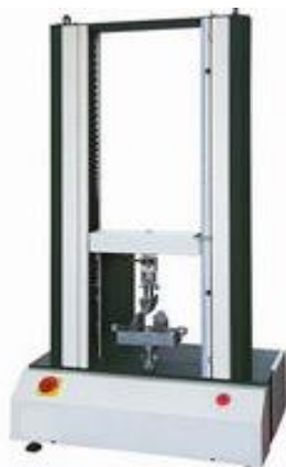
รูปที่ 2.14 เครื่องทดสอบความทนแรงอัด (Universal Testing Machine ) (ที่มา : thai.iqualitrol.com)
