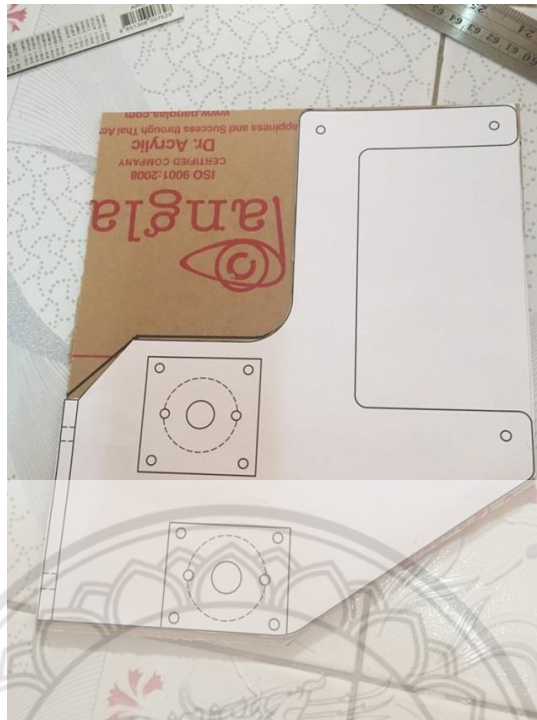
รูป ข.1 การติดแบบที่ออกแบบจากโปรแกรมลงบนแผ่นอะคริลิก
