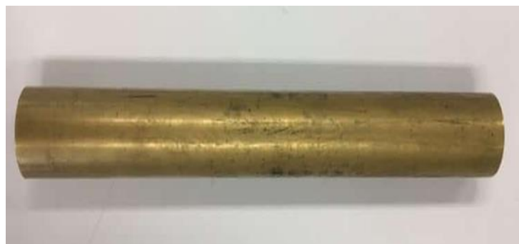
รูปที่ 3.19 เพลาทองเหลืองเส้นผ่านศูนย์กลาง 2.5 cm.
