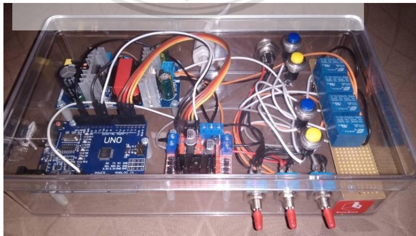
รูปที่ 3.6 ระบบควบคุมของชุดกัด
