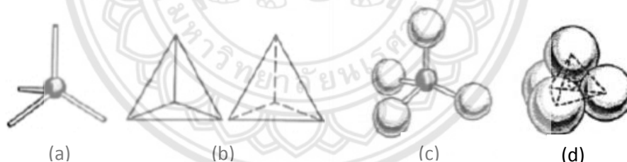
รูปที่ 2.11 ลักษณะ Tetrahedral Coordination ของออกซิเจนกับซิลิกา (a) Ball และ Stick Model, (b) Solid Tetrahedron, (c) Skeletal Tetrahedron, และ (d) Space-Filling Mode
