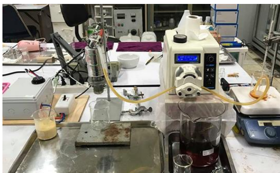
รูปที่ ก. 7 การดูดซับน้ำมันไบโอดีเซลด้วยซิลิกา
