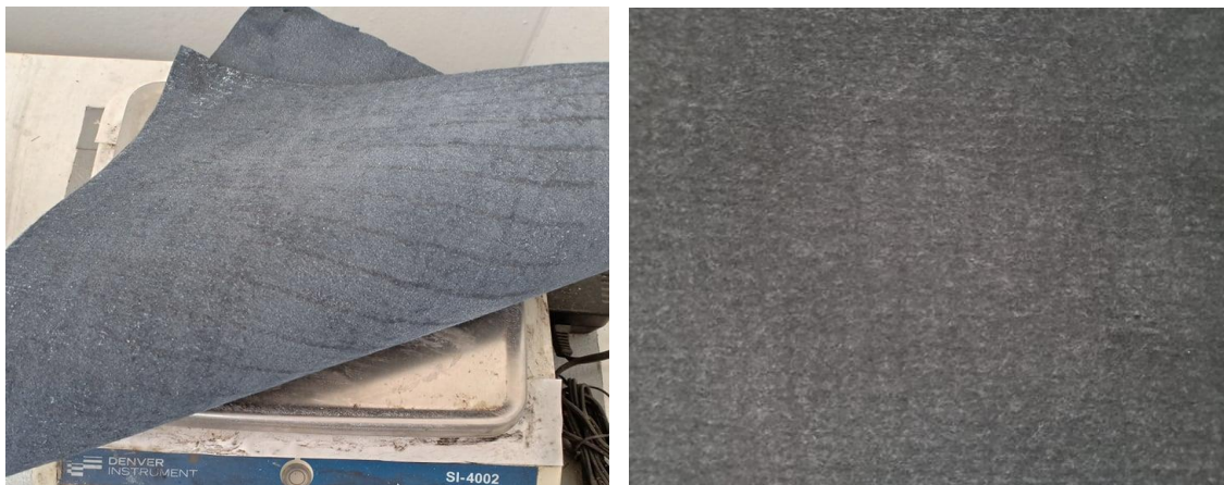
รูปที่ 26 การยึดเกาะของไททาเนียมไดออกไซด์บนแผ่นกรองคาร์บอนโดยวิธีแบบพันเคลือบ
