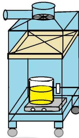
รูปที่ 17 หน่วยการกรองอากาศ
