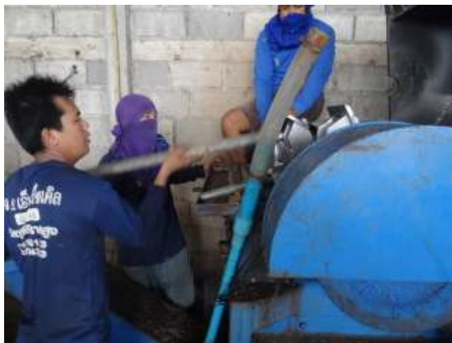
รูปที่ 4.10 แสดงพนักงานทำการขันนอตให้ครบและให้แน่น
