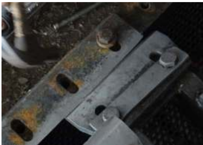
รูปที่ 4.8 แสดงใบมีดเล็กและใบมีดใหญ่ประกบกันพอดี
