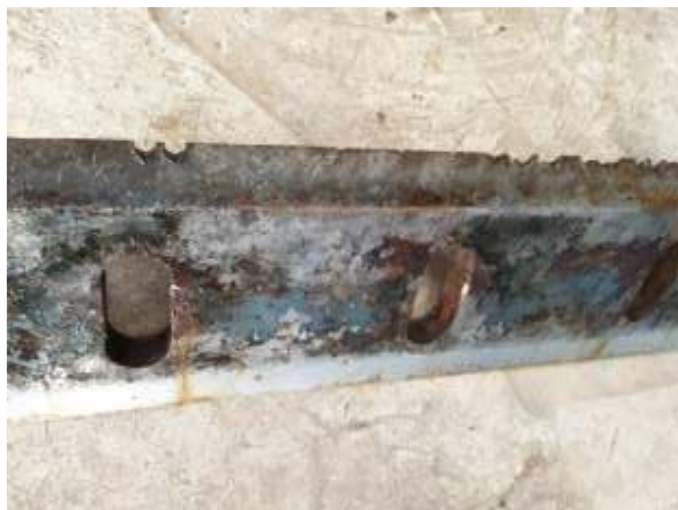
รูปที่ 4.23 ใบบิดที่เกิดการสึกกร่อน
