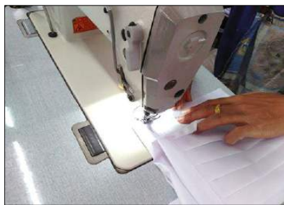
ก. พนักงานกำลังเย็บเทปติดกับตัวหมวก
