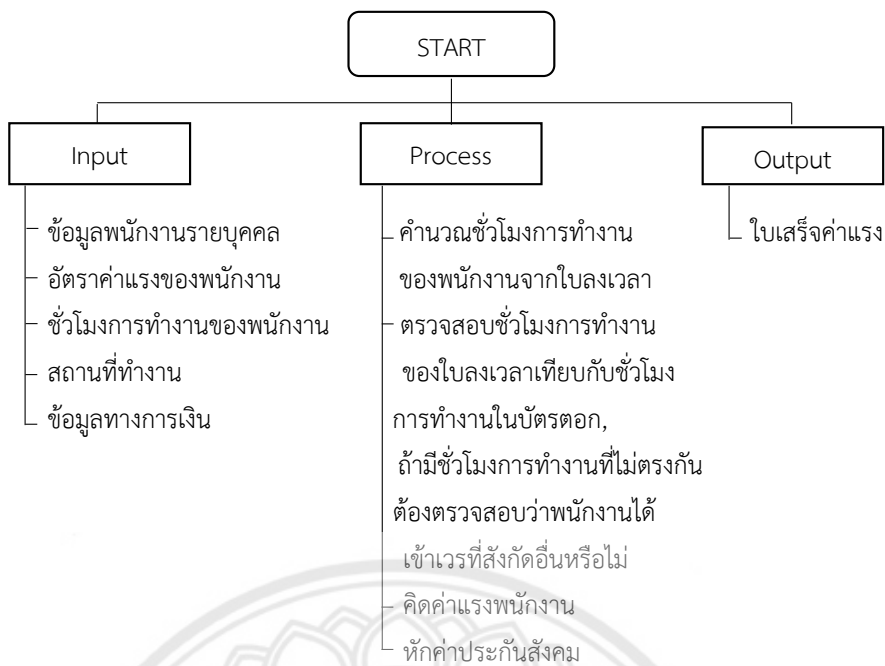
รูปที่ 3.3 แสดงแผนภาพการออกแบบโครงสร้างโปรแกรมช่วยในการคิดค่าแรงของพนักงานแบบเดิม
