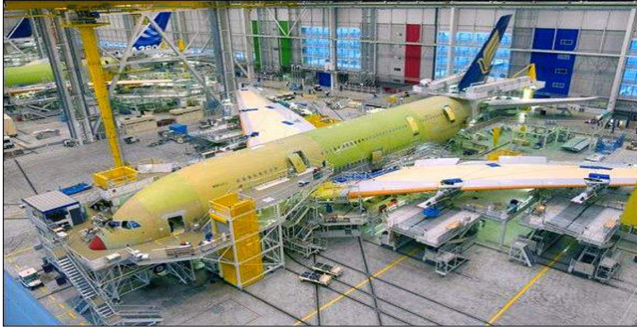
รูปที่ 2.7 แสดงการวางผังแบบอยู่กับที่ ที่มา : http://www.thailandindustry.com
