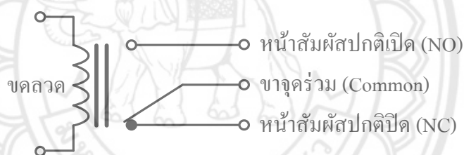
รูปที่ 2.13 สัญลักษณ์ภายในโครงสร้างของรีเลย์ (บ้านอิเล็กทรอนิกส์, 2554)
