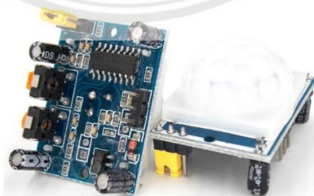
รูปที่ 2.22 มอดูลรับรู้การเคลื่อนไหวรุ่น HC-SR501
