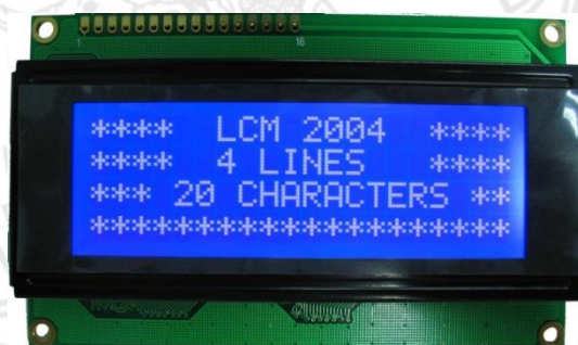
รูปที่ 2.19 จอแสดงผลแอลซีดี Hitachi หมายเลข HD44780 (บริษัท วินัสซัพพลาย จำกัด, 2555)
