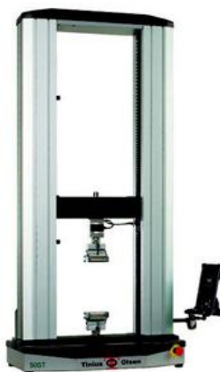
รูปที่ 2.22 เครื่องทดสอบความทนแรงอัด (Universal Testing Machine) (ที่มา: http://www.calservethailand.com )
