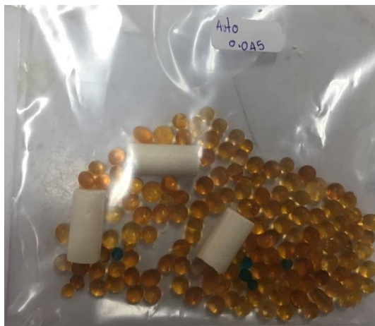
รูปที่ ค.8 นำยิปซัมที่ผ่านกระบวนการขึ้นรูปไปแกะออกจากหลอดและใส่ในซิลิกาเจล
