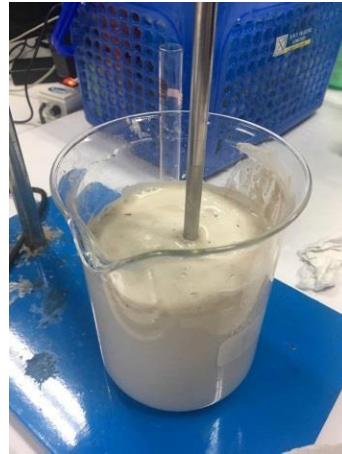
รูปที่ ค.2 การล้างยับซึ่มด้วยกรดซัลฟิวริก
