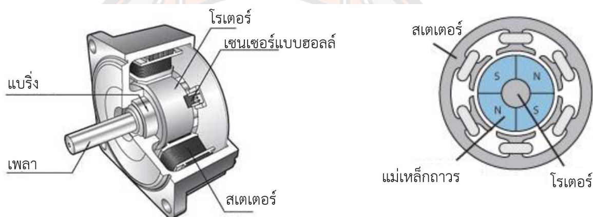
ภาพ 23 โครงสร้างภายในของมอเตอร์ไฟฟ้ากระแสตรงแบบไร้แปรงถ่าน
