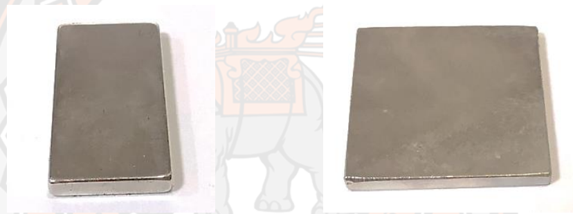
ภาพ 56 แม่เหล็กแรงสูงชนิดนีโอไดเมียม
