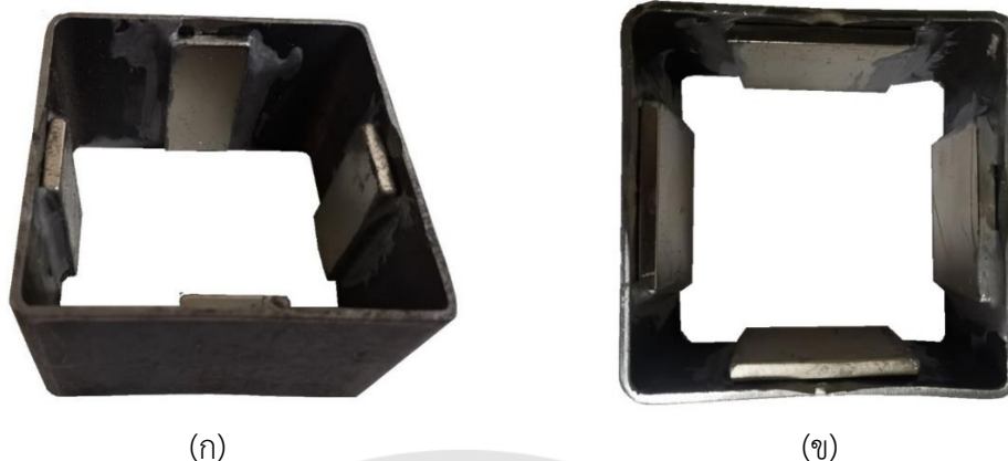
ภาพ 58 โครงสร้างสเตเตอร์สี่เหลี่ยมและแม่เหล็กจริง
