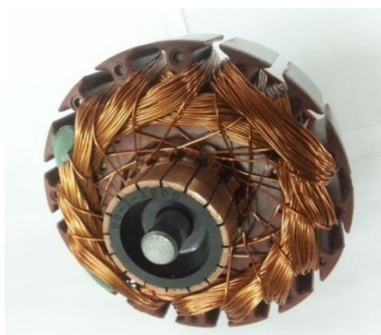
ภาพ 4 โรเตอร์ของมอเตอร์ที่ใช้ทดสอบ
