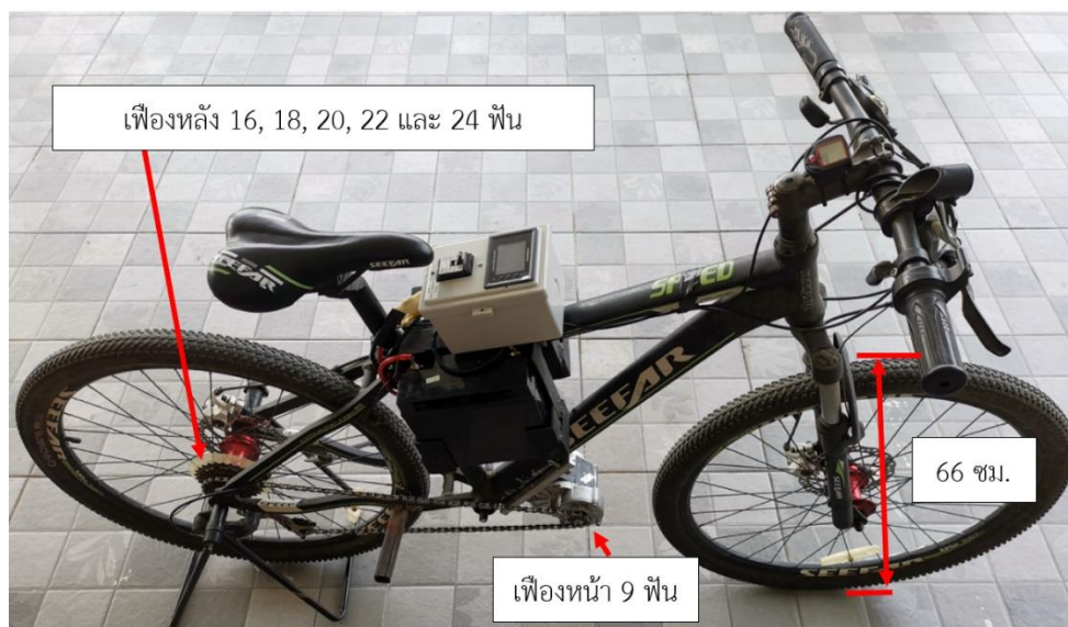
ภาพ 70 เฟืองและขนาดล้อจักรยานไฟฟ้าที่ใช้ในการทดสอบ
