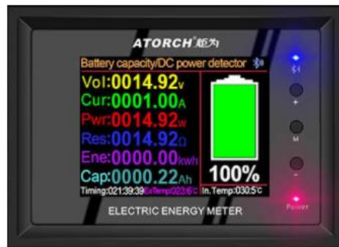
ภาพ 72 ค่าที่แสดงผลจากเครื่องวัดพลังงานไฟฟ้ากระแสตรง
