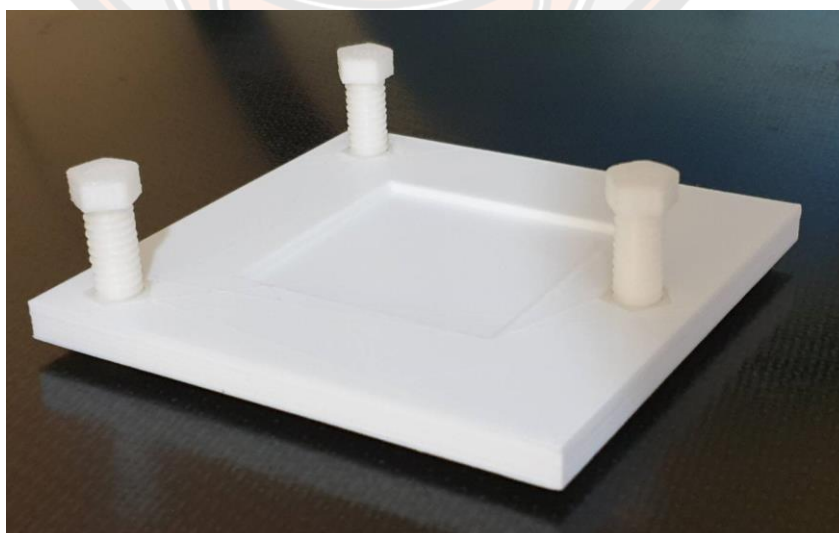
ภาพ 39 ชิ้นงานฐานปรับเอียงสำหรับทดสอบการเอียงของเตียงฉายรังสี
