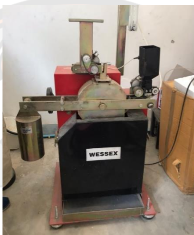
รูปที่ 3-15 เครื่องขัด (Accelerated Polishing Machine)
