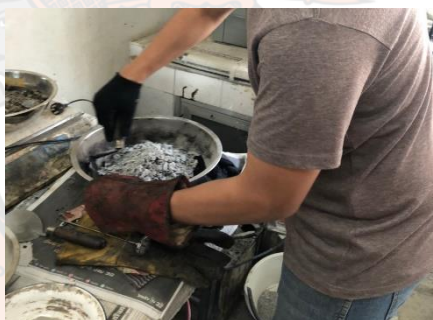
รูปที่ 3-63 ผสมวัสดุรวมและแอสฟัลต์ซีเมนต์ให้เข้ากัน
