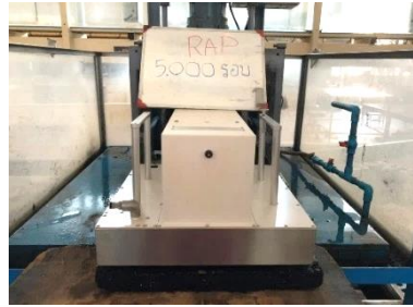
รูปที่ 3-70 ทดสอบความต้านทานการลื่นไถลด้วยเครื่องมือ Dynamic Friction Tester
