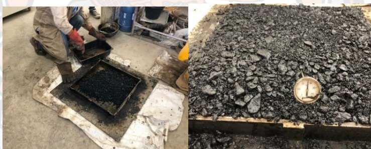
รูปที่ 3-66 เทส่วนผสมลงในแบบหล่อ
