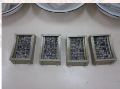
รูปที่ 3-20 วางเหล็กเสริมลงบนตัวอย่าง
