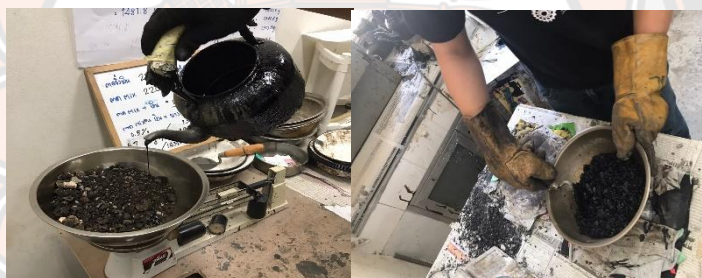
รูปที่ 3-61 ผสมวัสดุผิวทางเก่ากับวัสดุซีเมนต์ใหม่
