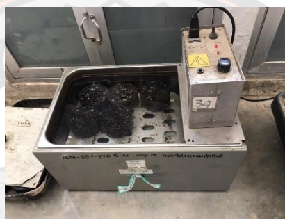
รูปที่ 3-58 แช่ตัวอย่างในน้ำก่อนการทดสอบเสถียรภาพ
