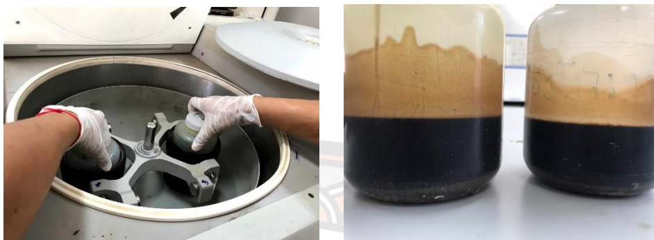
รูปที่ 3-34 นำตัวอย่างใส่เครื่องปั่นเหวี่ยงตกตะกอน
