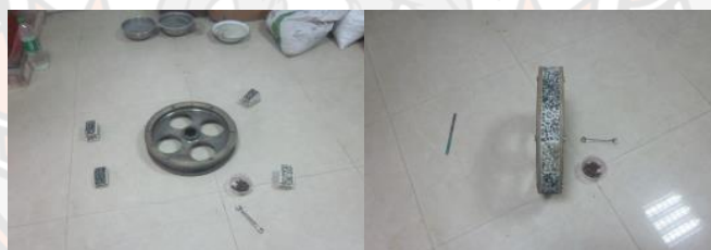
รูปที่ 3-25 นำตัวอย่างใส่วงล้อเหล็ก
