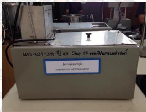
รูปที่ 3-39 อ่างน้ำปรับอุณหภูมิ
