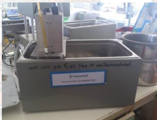
รูปที่ 3-44 อ่างน้ำปรับอุณหภูมิ
