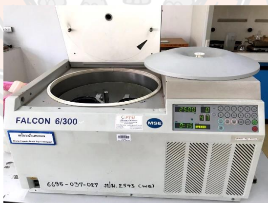
รูปที่ 3-31 เครื่องปั่นเหวี่ยงตกตะกอน (Centrifuge machine)
