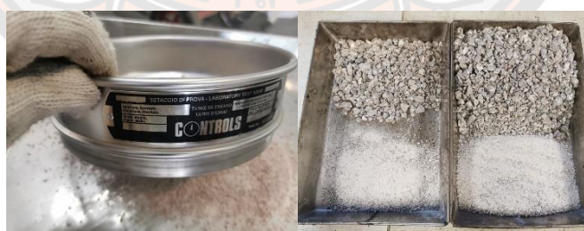
รูปที่ 3-10 ร่อนตัวอย่างผ่านตะแกรงขนาด 2.36 มิลลิเมตร ในการทดสอบ AIV
