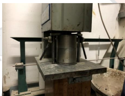
รูปที่ 3-56 นำตัวอย่างเข้าเครื่องบดอัด
