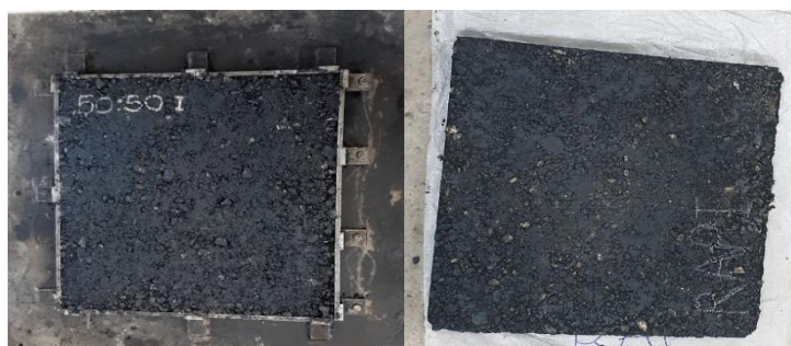
รูปที่ 3-67 ทิ้งตัวอย่างไว้ให้เย็น และนำออกจากแบบ
