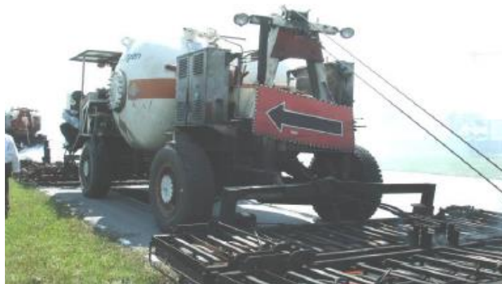
รูปที่ 2-13 เครื่อง Pre-heater (กรมทางหลวง, 2012)
