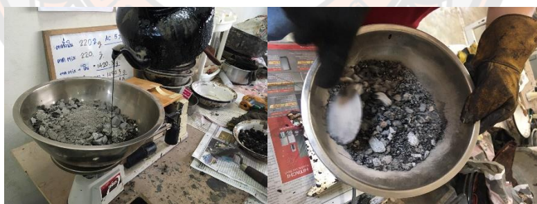
รูปที่ 3-54 นำมวลรวมและแอสฟัลต์ซีเมนต์ผสมให้เข้ากัน
