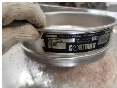
รูปที่ 3-14 ร่อนตัวอย่างผ่านตะแกรงขนาด 2.36 มิลลิเมตร ในการทดสอบ ACV
