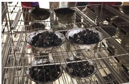
รูปที่ 3-60 ให้ความร้อนกับวัสดุผิวทางเก่า (RAP)
