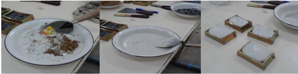
รูปที่ 3-21 หล่อตัวอย่างด้วยปูนซีเมนต์กับทรายละเอียด
