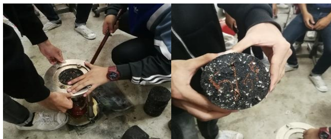
รูปที่ 3-57 นำตัวอย่างออกจากแบบ และทิ้งตัวอย่างไว้ที่อุณหภูมิห้อง
