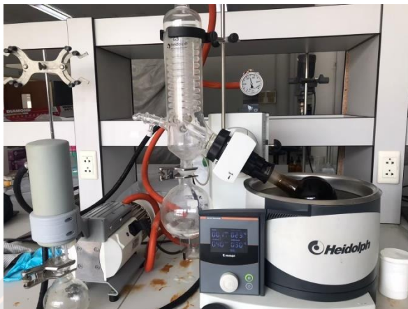
รูปที่ 3-32 เครื่องกลั่นสารแบบสุญญากาศ (Rotary evaporator machine)
