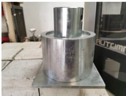
รูปที่ 3-12 เหมวลวัสดุออกจากกระบอกตวงลงในแบบเหล็กทรงกระบอก
