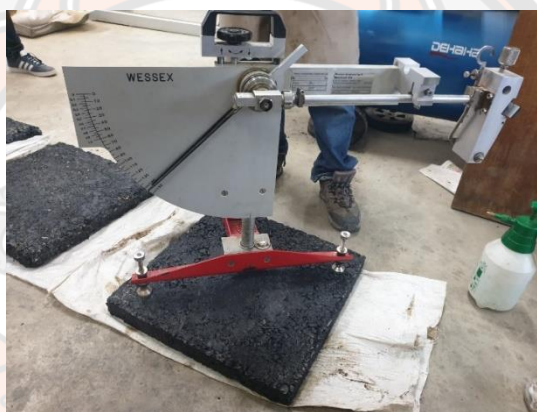
รูปที่ 2-8 เครื่องมือทดสอบ British Pendulum Tester (BPT)
