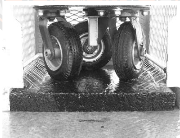
รูปที่ 2-7 ระบบสเปรย์น้ำเพื่อจำลองสภาพผิวถนนแบบเปียก (Wet Condition) (NCAT, 2006)
