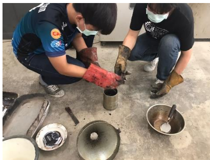
รูปที่ 3-55 ใส่ตัวอย่างลงในแบบ และแซะตัวอย่างก่อนเข้าเครื่องทดสอบ
