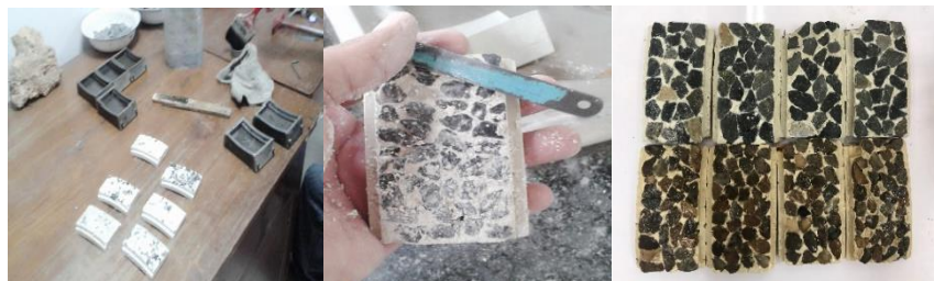
รูปที่ 3-23 ถอดตัวอย่างออกจากแบบ และตกแต่งผิวหน้าตัวอย่าง
