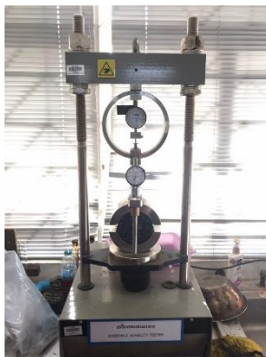
รูปที่ 3-59 การทดสอบเสถียรภาพ และการไหล
