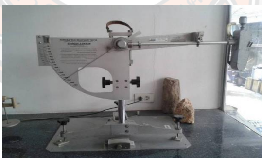
รูปที่ 3-16 เครื่องวัดความต้านทานการสิ้นไถล (British Portable Tester)
