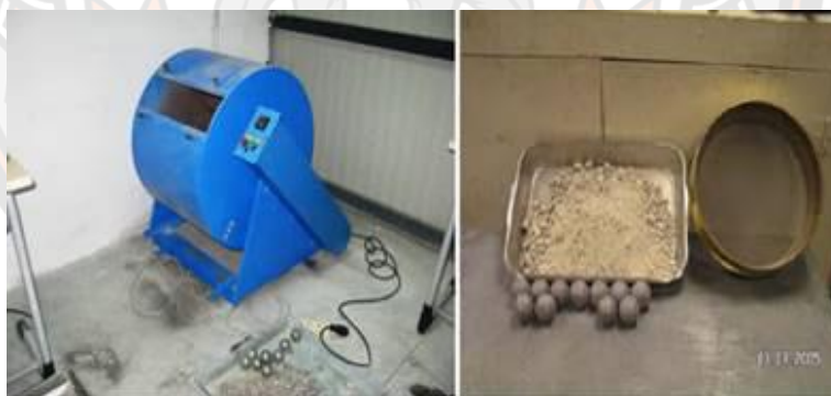
รูปที่ 3-28 การทดสอบความสึกหรอของหินย่อย กรวดย่อย กรวด
