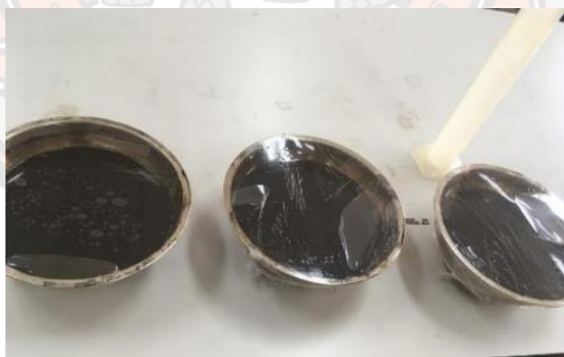
รูปที่ 3-33 แช่วัสดุผิวทางเดิมด้วยตัวทำละลายไดคลอโรมีเทน
