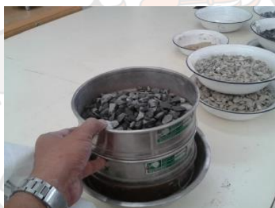
รูปที่ 3-17 ร่อนตัวอย่างผ่านตะแกรง
