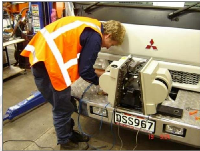
ภาพ 18 การติดตั้งอุปกรณ์เลเซอร์
