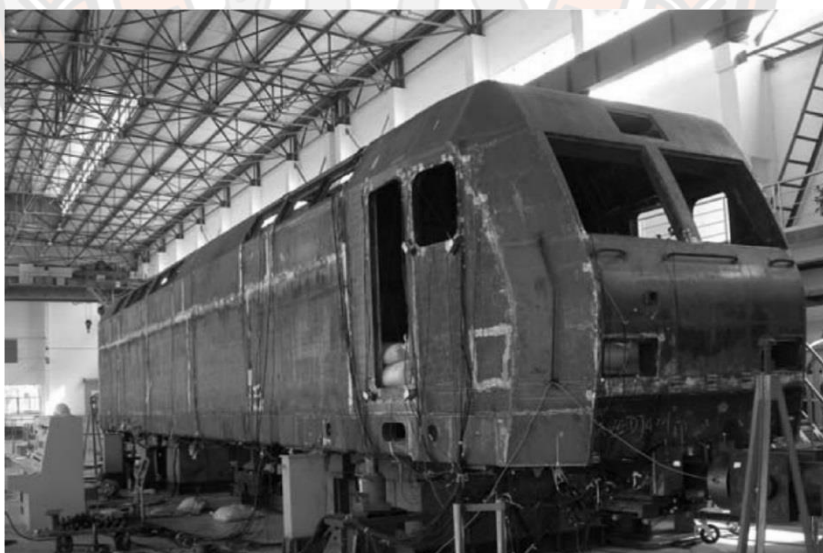
ภาพ 6 ตัวอย่างโครงสร้างแบบผนังรถ ผลิตโดย CRRC Zhuzhou Electric Locomotive Co. Ltd, Zhuzhou, China
