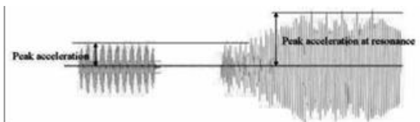
ภาพ 21 การสั่นสะเทือนของสะพานในสภาวะปกติและสภาวะสั่นพ้อง (resonance)
