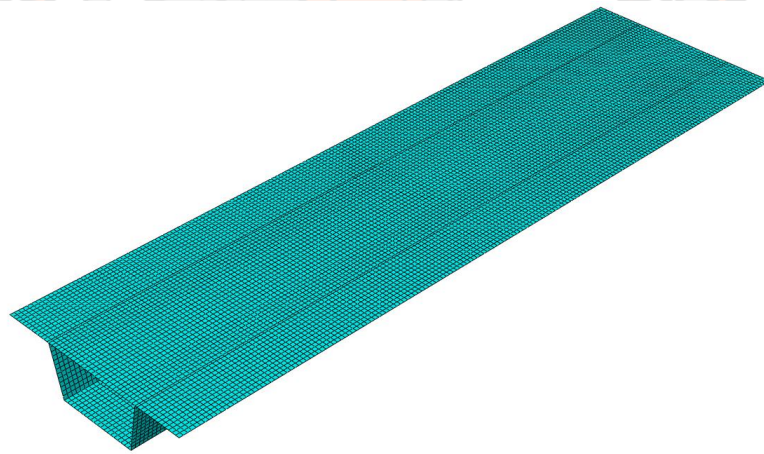
ภาพ 49 ตัวอย่างรูปร่างของแบบจำลองสะพานแบบระเบียบวิธีไฟไนต์เอลิเมนต์ (Finite Element Method)
