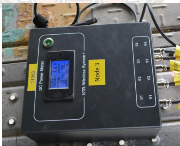
ภาพ 41 อุปกรณ์ Data Logger ที่ใช้ในการตรวจวัด
