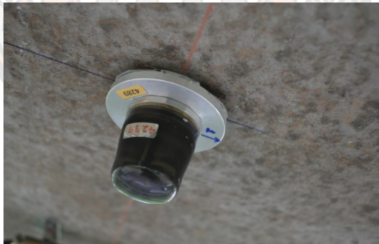
ภาพ 39 Accelerometer ที่ใช้ในการตรวจวัด
